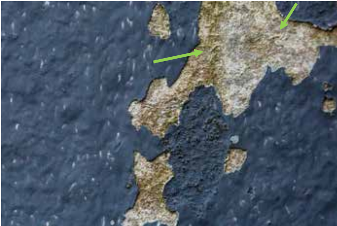
Figuur 46: Voorbeeld van vrijkomende chrysotielvezelbundels door degradatie (vocht) van geverfde steunpalen in vezelcement
