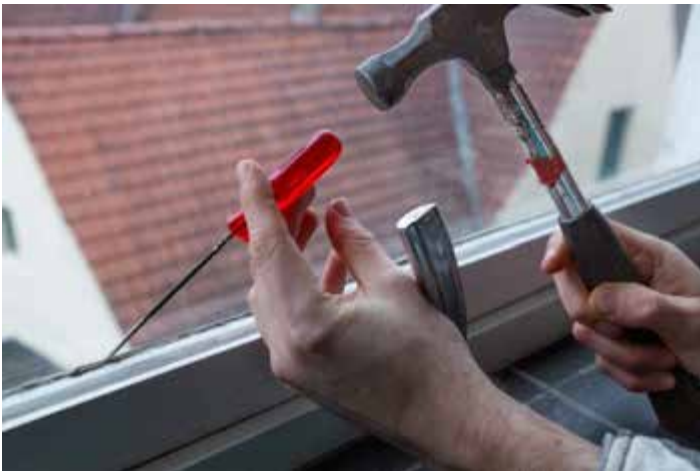
Figuur 59: Voorbeeld van een zorgvuldige monstername van mastiek met fijne platte schroevendraaier
