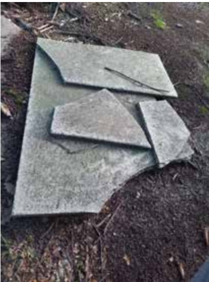
Figuur 14: Voorbeeld van een niet-constructie: stukken van platen in vezelcement (afval)
