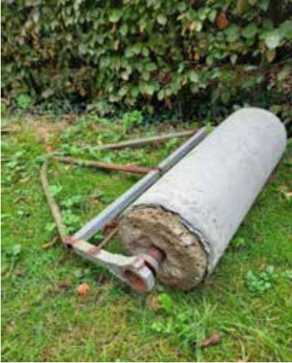
Figuur 13: Voorbeeld van een niet-constructie: asbestcementen tuinwals in gebruik (roerend goed)
