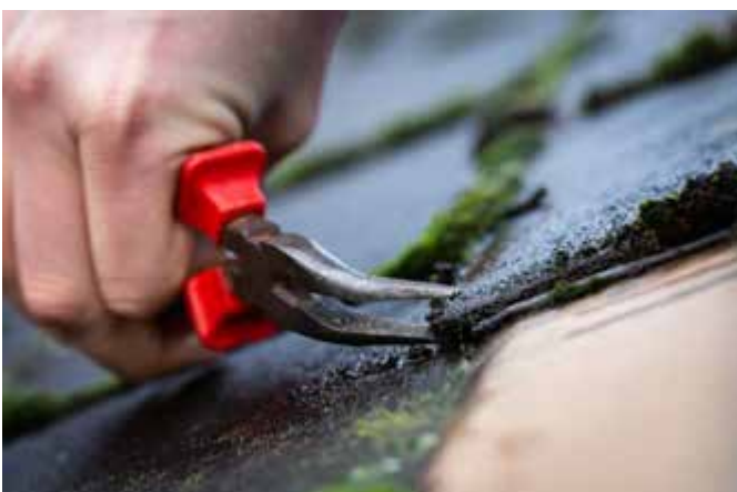
Figuur 62: Voorbeeld van een zorgvuldige monsterneming van leien in vezelcement met bektang
