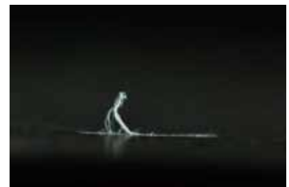
Figuur 1: Voorbeeld van een chrysotielvezelbundel
